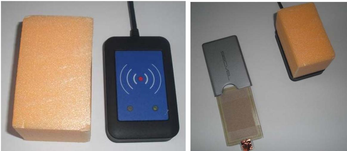
**Abbildung 5.6:** 13,56 MHz RFID-Tischlesegerät mit 5 cm Distanzstück aus Hartschaumstoff (links) und Messantenne im Scheckkartenformat beim Einstecken in die *SECVEL-Kartenschutzhülle* (rechts, Hartschaum-Distanzstück bereits auf RFID-Lesegerät aufgelegt).
