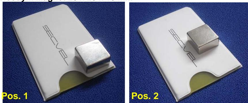
Abbildung 5.4: Positionierung des Spielmagnets und anderer Neodym Magnete auf der *SECVEL*-Kartenschutzhülle während der Magnetfeldmessungen im Inneren der Hülle
