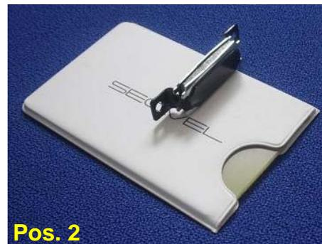
Abbildung 5.3: Positionierung der Pinwandmagneten und des Türverschlussmagnets auf der SECVEL-Kartenschutzhülle während der Magnetfeldmessungen im Inneren der Hülle
