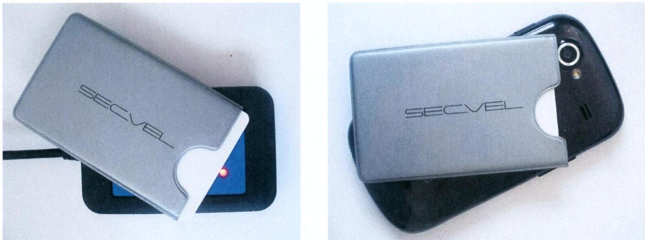
**Abbildung 1.2:** Konfigurationen (Einstecktiefen von Karten) bei denen ein RFID-Zugriff bei Berührung des Lesegerätes bzw. des Smart Phones noch möglich war
