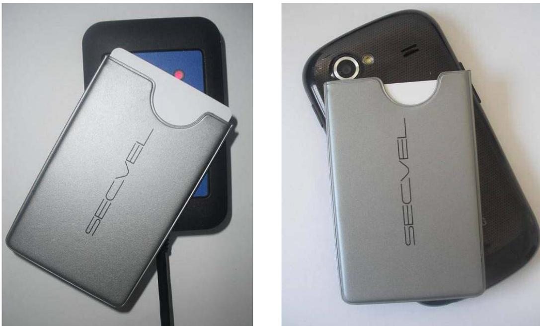
**Abbildung 5.8:** Beispiele für die untersuchten Szenarien zur Untersuchung der Frage, in wie weit ein nicht vollständiges Einstecken der Karten in die *SECVEL-Kartenschutzhülle* die feldschwächende Wirkung der *SECVEL-Kartenschutzhülle* unterminiert. Links: Versuche mit einem RFID-Tischlesegerät; rechts: Versuche mit einem Smart Phone mit NFC-Schnittstelle
