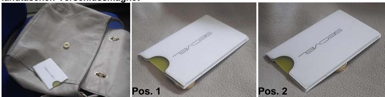
Abbildung 5.5: Positionierung der Handtaschen-Verschlussmagnete auf der *SECVEL*-Kartenschutzhülle während der Magnetfeldmessungen im Inneren der Hülle (nur eine der drei Handtaschen dargestellt).
