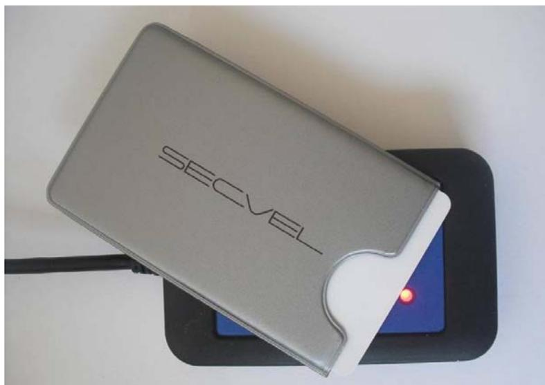
Abbildung 7.4: Bei nicht vollständig in die *SECVEL-Kartenschutzhülle* eingesteckter Karte war ein Auslesen der Karte mit dem verwendeten Tischlesegerät, bei Berührung der Lesegerät Oberfläche möglich
