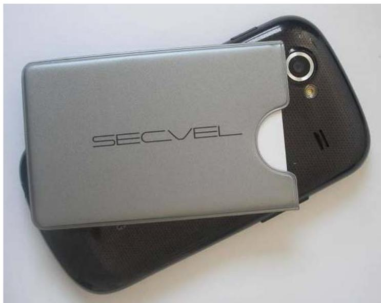
**Abbildung 7.5:** Sogar bei vollständig in die *SECVEL* Kartenschutzhülle eingesteckter Karte war ein Auslesen der Karte mit dem verwendeten Smart Phone, bei Berührung der Smart Phone Oberfläche möglich
