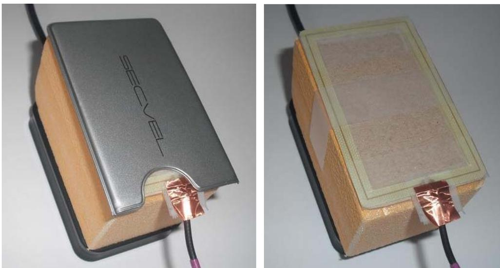
**Abbildung 5.7:** Messanordnung zur Bestimmung der Abschwächung des 13,56 MHz Magnetfeldes vom RFID-Lesegerät durch die *SECVEL-Kartenschutzhülle*. Links: Messung mit Antenne vollständig in die *SECVEL-Kartenschutzhülle* eingesteckt; rechts: Messung ohne *SECVEL-Kartenschutzhülle*
