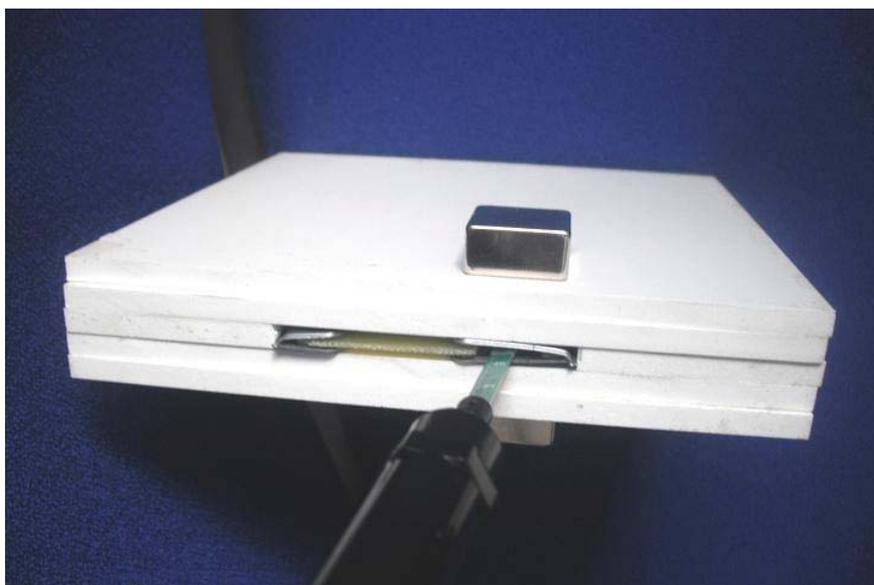
Abbildung 5.2: Messanordnung zur Bestimmung der Abschwächung eines äußeren Magnetfelds durch den Prüfling im Bereich des Magnetstreifens
